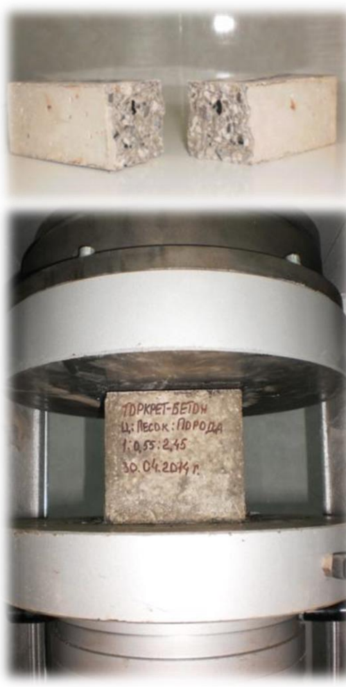
Визначення міцності зразків матеріалу на пресі «Tescnotest KL 200 / CE» (виробн. Італія)
