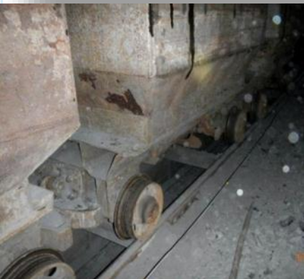
Вагони з донним розвантаженням з породою, що надходить на дробарку
