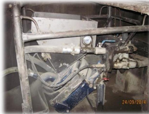
Торкрет-машина АС-1П (АТ "Альпсервіс", м. Харків)
