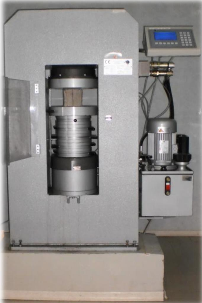
Визначення міцності зразків матеріалу на пресі «Tescnotest KL 200 / CE» (виробн. Італія)
