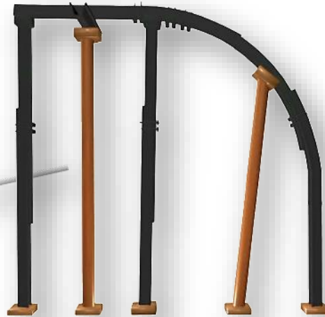
Проектна форма кріплення з підсиленням жорсткими (дерев'яними) і податливими (СВП) стійками
