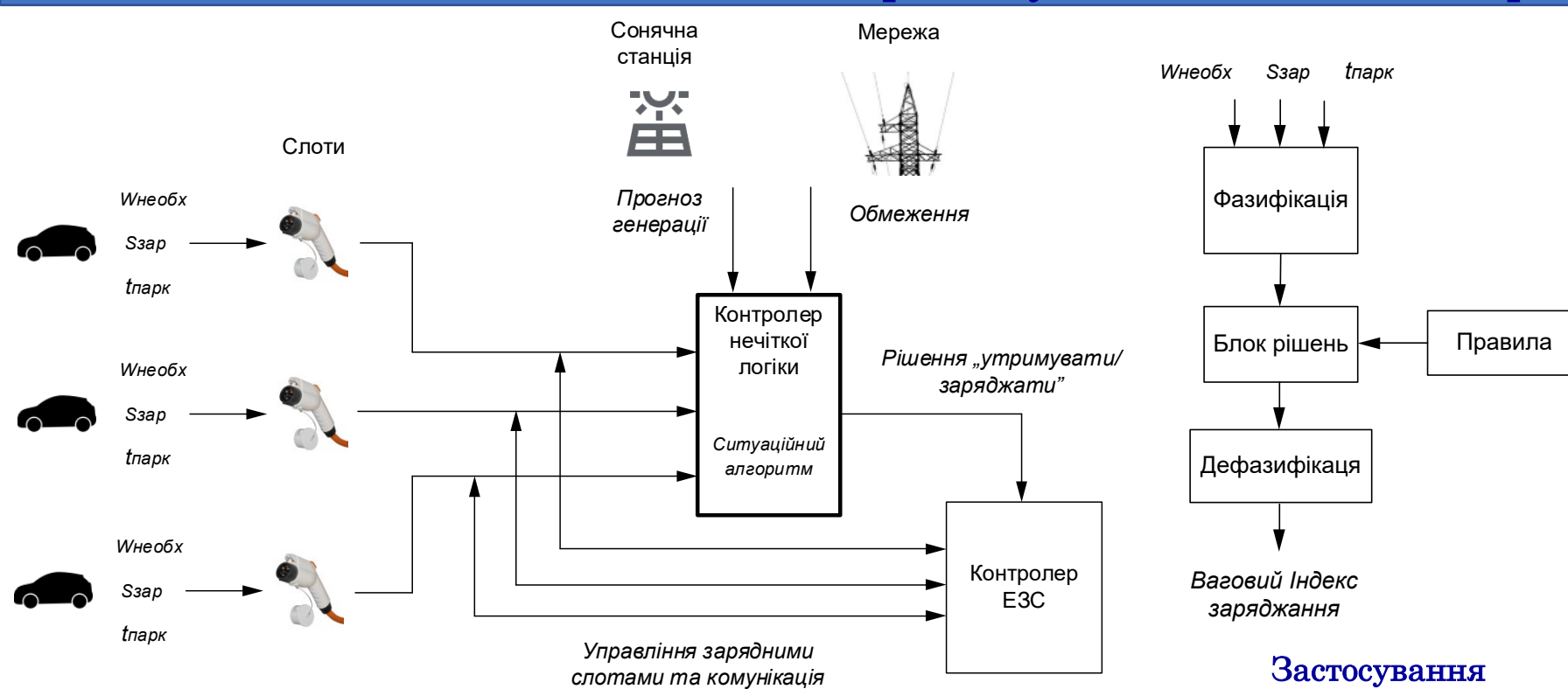
Структура системи керування зарядною станцією
