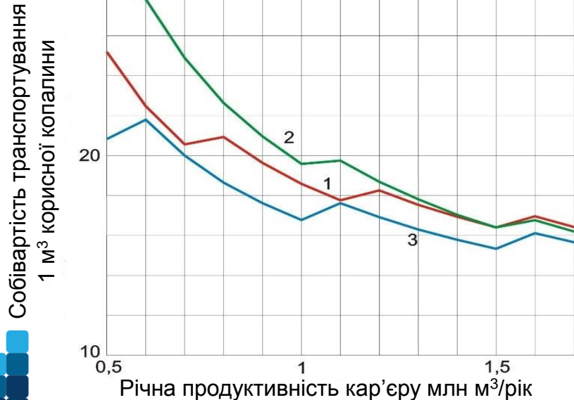
Рисунок 41 – Графік зміни собівартості транспортування 1 м³ глини в залежності від виробничої потужності кар'єру для роботи за різними схемами
