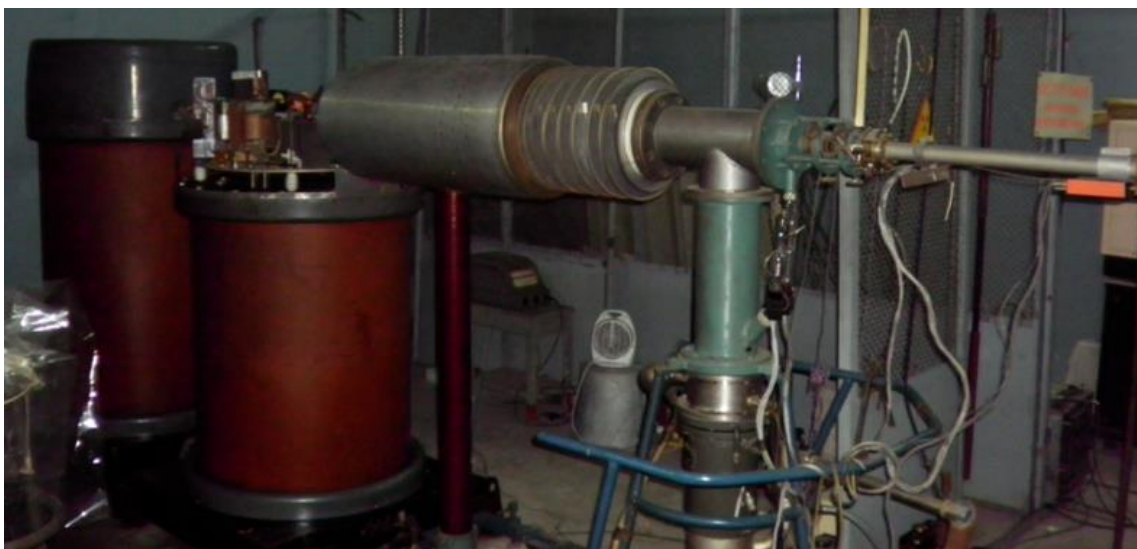
Імпульсний нейтронний генератор ІНГ-200 КНУ імені Тараса Шевченка
