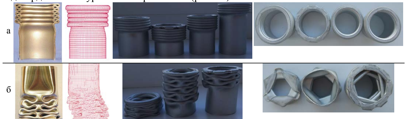
Рис. 14. Характер деформації ЕПЕ в залежності від співвідношення діаметра профілю до товщини його стінки ( d/b ): а - вісесиметричний. б - невісесиметричний
