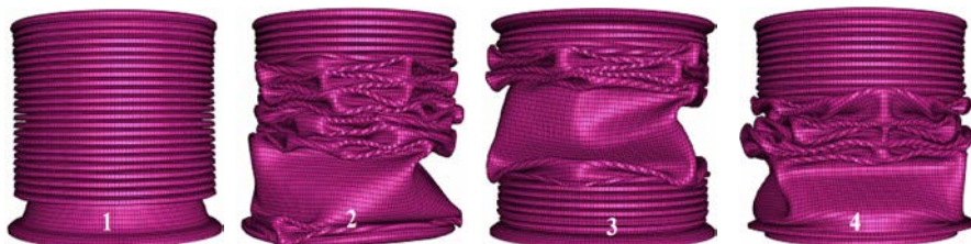
Рис. 6. Режими деформації при прогресивній втраті стійкості ЕПЕ: 1 – вісесиметричний, 2 – невісесиметричний, 3 – вигин, 4 – змішаний
