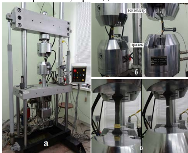
Рис.11. Випробувальна машина ViSS-100: а - загальний вигляд; б і в - зразки до і після
