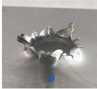
Діаграми навантаження при продавлюванні зразків конічним пуансоном зі швидкостями 5 м/с (зразок V1-3) та 3 м/с (зразок V6-3) (а) зовнішній вигляд зразка V6-3 після руйнування (б)
