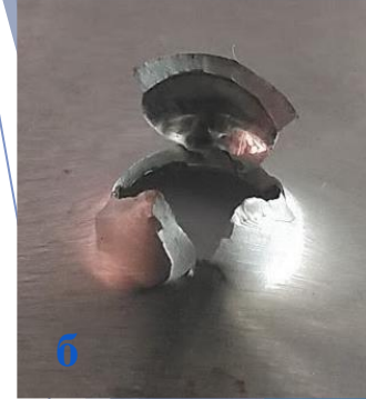
Діаграми навантаження при продавлюванні зразків напівсферичним пуансоном зі швидкостями 5 м/с (зразок U1-3) та 3 м/с (зразок U5-3) (а) зовнішній вигляд зразка U5-3 після руйнування (б)
