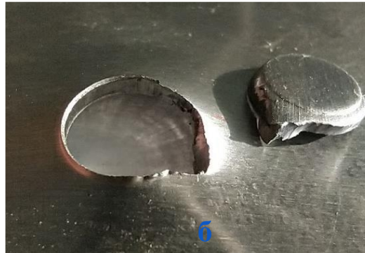
Діаграми навантаження при продавлюванні зразків плоским пуансоном зі швидкостями 5 м/с (зразок T1-3) та 3 м/с (зразок T4-3) (а) зовнішній вигляд зразка T4-3 після руйнування (б)
