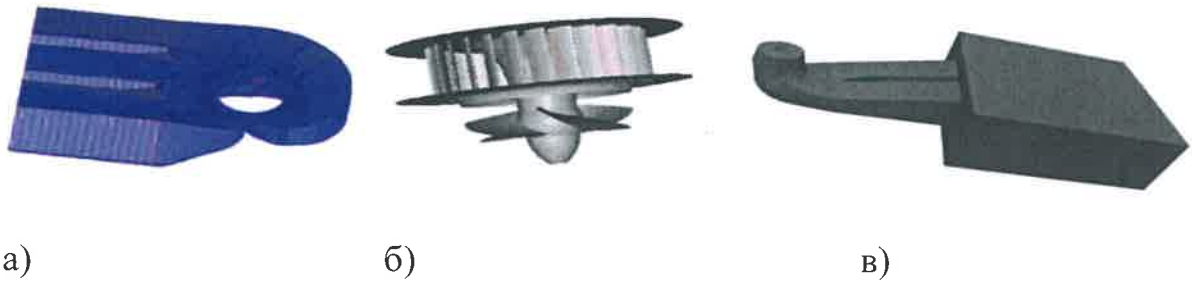
Рисунок 1 – Комп'ютерна модель проточної частини гідротурбіни: а) спіральна камера і статор; б) направляючий апарат і робоче колесо; в) відсмоктуюча труба з баком
