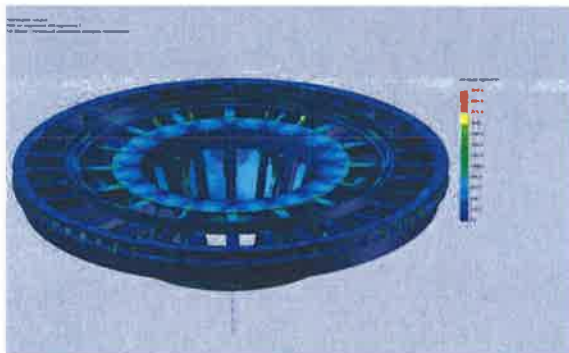
Рисунок 2. Розподіл інтенсивності напружень у кришці турбіни
