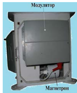
Рис.3. Вигляд приладу 1П132 зі знятою кришкою із боку модулятора та магнетрона передавача РЛС «Буревісник-1»
