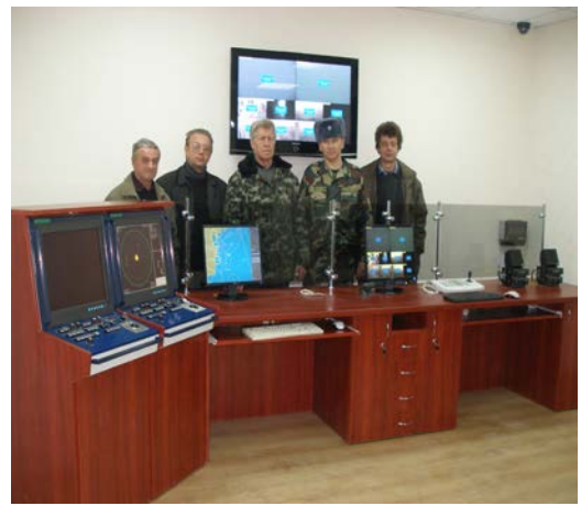
Рис.12. Стька із пультом керування, системою живлення, спец обчислювачем, системою запуску синхронізації та контролю (прилад 1П-54) і стійка електронної картографічної навігаційної системи (ЕНІКС) (прилад 1П-54-1, входить до складу РЛС «Буревісник-4» на посту спостереження о. Змийний Одеського загону ДПС України.
