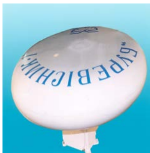
Рис.1. Загальний вигляд приймача-передавача із антеною, яка закрита обтічником (стійка 1П132) РЛС Буревісник-1»
