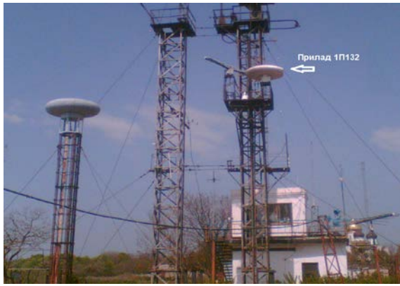
Рис.9. Приймач-передавач (прилад 1П-132) РЛС «Буревісник-1» на вищій поста спостереження Одеського прикордонного загону ДПС України.
