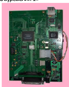
Рис.2. Вигляд приймача-передавача із відкритою кришкою обтічника антени (стійка 1П132) РЛС Буревісник-1»
