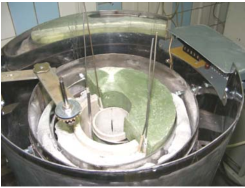
Установка для вимірювання тепло- та електропровідності сипучих тіл
