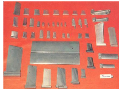
Рис. 16 – Зовнішній вигляд тонкостінної продукції для авіадвигунобудування
