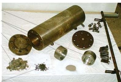
Рис. 1 – Трикамерний вибухоударний контейнер - у розібраному вигляді при сортуванні кришива на розмірні фракції
