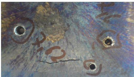
Рис. 11 – Комбінована багатошарова бронезахисна пластина після прострілу пулями калібру 7.62 та 5.56
