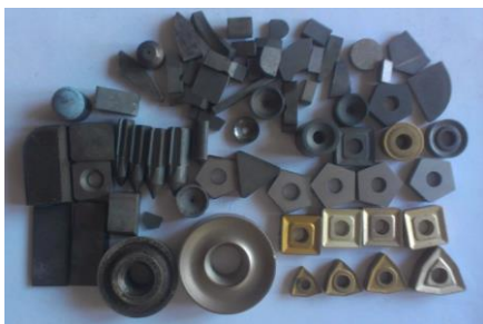
Рис. 14 – Зовнішній вигляд виробів з регенованих твердих сплавів зі зміцненням
