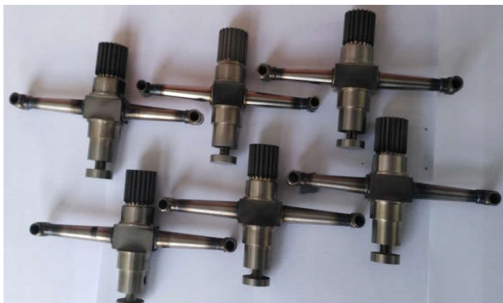
Рис. 12. Деталь газового приводу крила ракет з 6-ти компонентного евтектичного сплаву.
