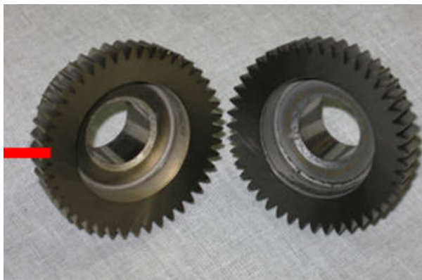
Рис. 13. Довб'яки зі швидкоріжучої сталі Р6М5К5МП та Р18 з нанесеним надтвердим покриттям (TiVZrNbHfTa)N.
