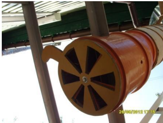
Вихідний отвір для регулювання продуктивності установки
