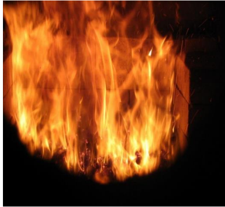
Схема класичної реторти і фото полум'я над нею : тирса, W=30\% , q=260\text{кВт/м}^2 , \text{CO} = 1850\text{ ppm} ; \text{NO}_x=75\text{ ppm}
