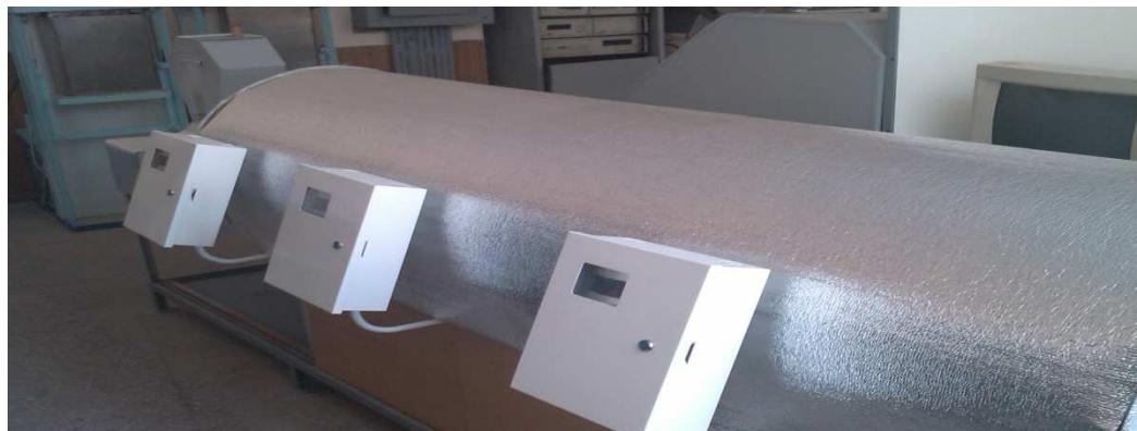
В стрічковій мікрохвильовій установці в широкому діапазоні регулюються: швидкість стрічкового приводу, продуктивність завантаження. Потужність випромінювачів має ступеневе регулювання в діапазоні 30 – 100% потужності магнетрону. Стендові випробування установки визначили її високі технічні характеристики. Установка має послідовні зони мікрохвильової та інфрачервоної дії на продукт. Регулювання потужності – імпульсна модуляція.
