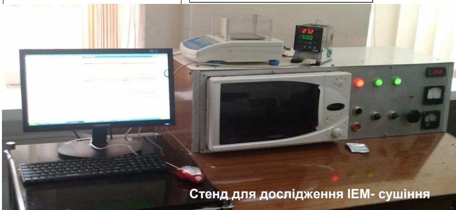
Стенд для дослідження IEM- сушіння
