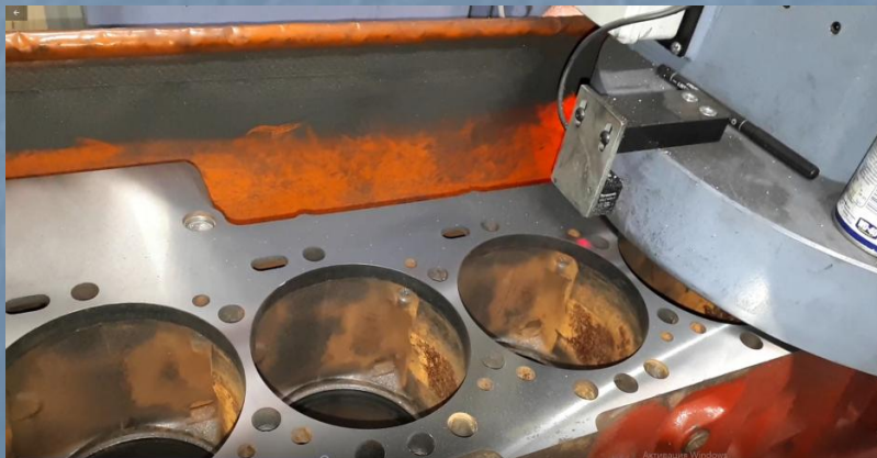
Оброблювана площа блоку циліндрів комбайна "Case" після фрезерування інструментом з модифікованим ПКНБ
