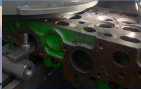
ГБЦ комбайну John Deere із чавуну на якій проводилися випробування розроблених різальних композитів із ПКНБ
