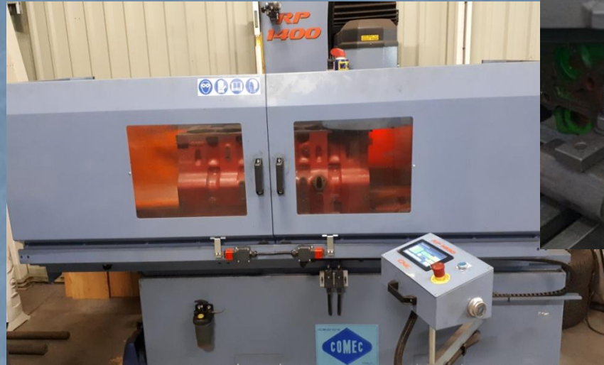
Фрезерний верстат Comec RP 1400 для фрезерування роз'ємних частин блоків циліндрів (ТОВ «Ерідон Тех», м. Полтава)
