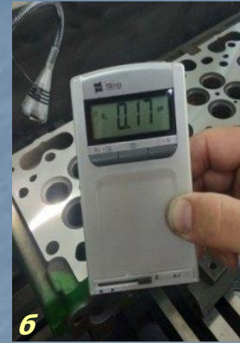
Шорсткість поверхні до обробки (а) та після обробки різцями з пластинами із ПКНБ (б)
