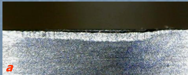
Контактні поверхні інструменту з ПКНБ «Борсиніт» після обробки загартованої сталі ХВГ (HRC 56–58) при v = 120 \text{ м/хв} (a) і v = 210 \text{ м/хв} (б) ( t = 0,2 \text{ мм}, S = 0,1 \text{ мм/об} )
