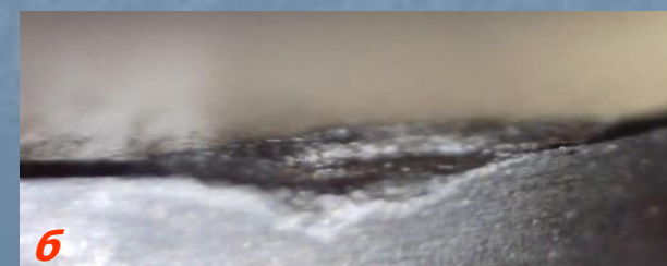
Зруйновані ділянки різальної кромки інструменту з ПКНБ-ВЛ після обробки загартованої сталі ХВГ (56–58 HRC) при v = 120 \text{ м/хв} (a) і v = 210 \text{ м/хв} (б) ( t = 0,2 \text{ мм}, S = 0,1 \text{ мм/об} )
