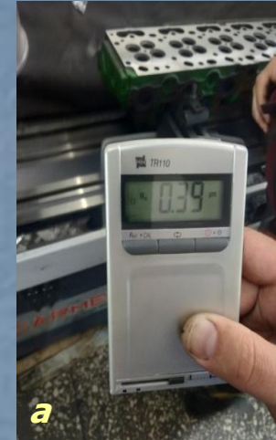
Шорсткість поверхні до обробки (а) та після обробки різцями з пластинами із ПКНБ (б)
