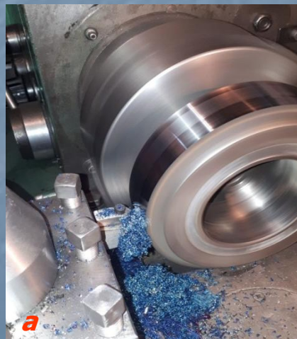
Процес точіння прокатного валка інструментом із ПКНБ (а); прокатні валки, які використовуються підприємством (б); матеріал – загартована нержавіюча сталь X12 (60–64 HRC) (ПрАТ «Трубосталь», м. Коростень)
