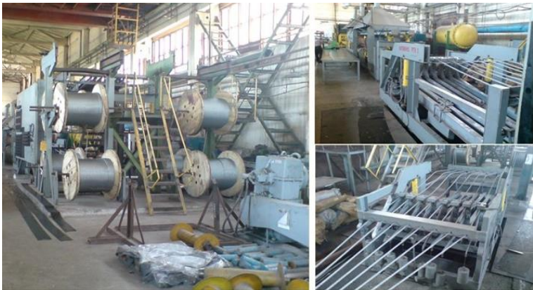
Рис. 4 – Лінія з виробництва еластомерно-тросових канатів у м. Кривий Ріг
