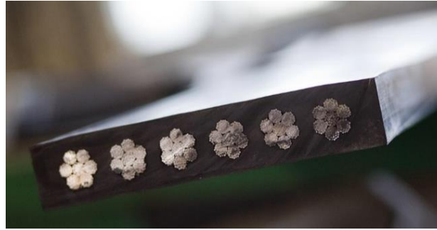
Рис. 2 – Багатошарова ванта необхідної тягової спроможності, складена із композитних еластомерно-тросових канатів
