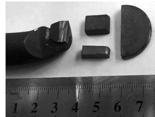
Пластини виготовлені з шихти системи Fe – Ti – C
